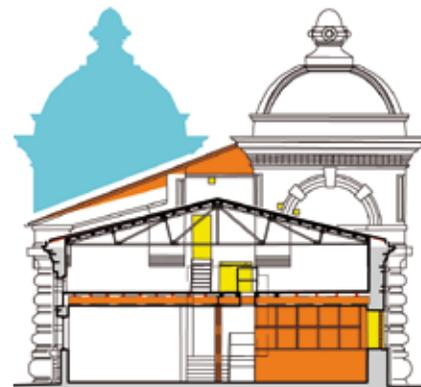
le weichen. In die Ostfassade wurden Fensteröffnungen eingebrochen und mit Glasbausteinen verschlossen. Die Halle erhielt eine Zwischendecke, die 2006 im Zuge der Entkernungen entfernt wurde. Die Schnittansicht gegen den Akkumulatorenturm zeigt links, dass eine mächtige Konsole für den Bau des zweiten Turms (blau) bereits vorgerichtet war. Im Untergrund wurde bei Ausschachtungen der Abgaskanal der Dampfessel zum Schlot gefunden und dokumentiert.
