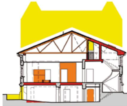
dekorierte späthistoristische Fassade zweigeschossig mit mächtigem Dach ausgeführt. Nach der Zerstörung 1945 erfolgte ein reduzierter Wiederaufbau mit einfachem Nagelbinderdach. Eines von zwei Treppenhäusern wurde erhalten, ebenso die ursprüngliche Struktur des Kellers. Als „Zucker-Goebel“ erfuhr dieses Bauteil die am weitesten gehenden Veränderungen des gesamten Ensembles und wurde so als Torso in das Konzept der Kunsthalle integriert.
